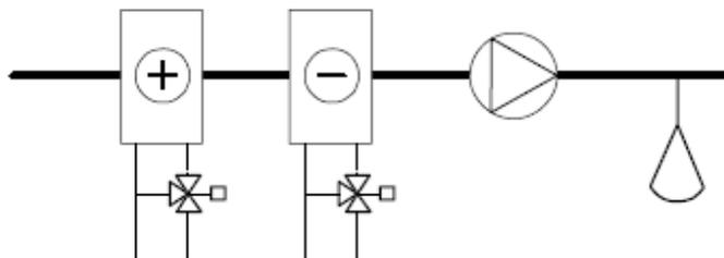
Для режима работы 2 «регулирование температуры приточного воздуха с компенсацией температуры наружного воздуха» необходимо 2 датчика датчик приточного воздуха, подключаемый к AI1, и наружный датчик подключаемый к AI2.
