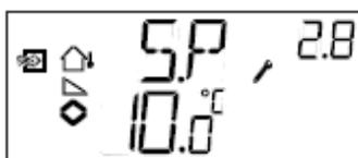
В режиме работы 3 температура приточного воздуха имеет верхнее и нижнее ограничение. В этом меню устанавливается минимальное значение температуры приточного воздуха.
