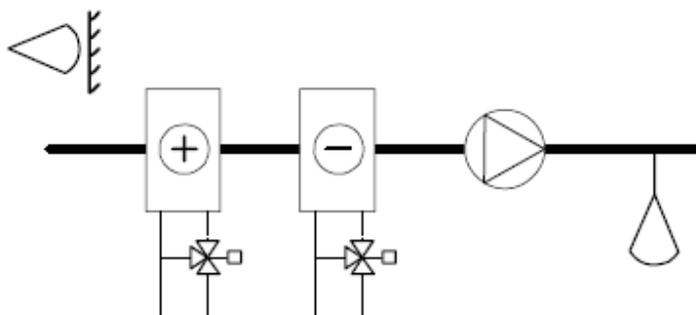
Для режима работы 3 «Каскадное регулирование / регулирование температуры приточного воздуха» необходимо также 2 датчика - датчик приточного воздуха, подключаемый на AI1 и второй - комнатный датчик или датчик вытяжного канала подключаемый к AI2.
