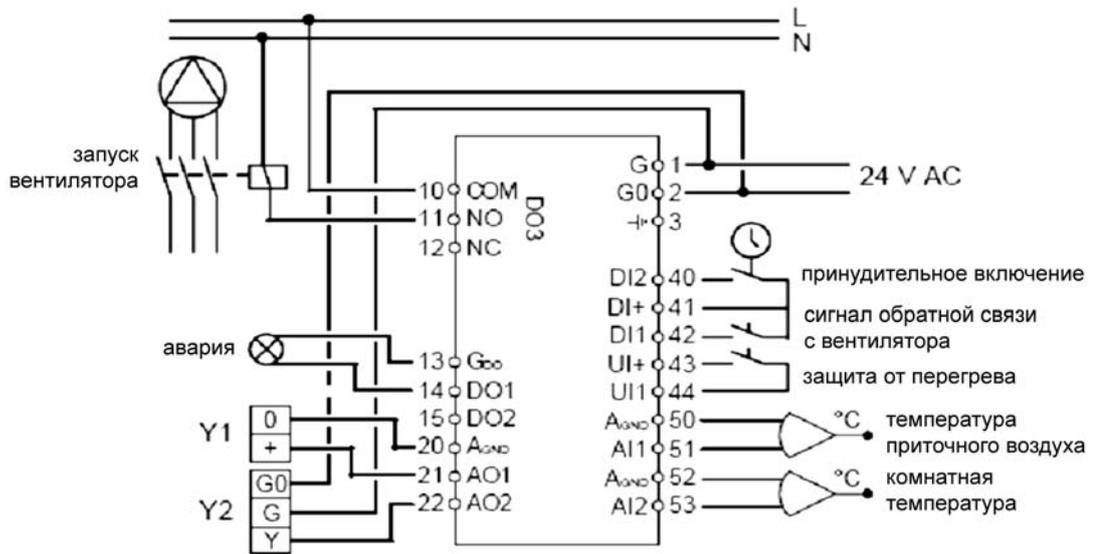
В. ОР10-230 Регулирование температуры приточного воздуха с компенсацией температуры наружного воздуха, с помощью водяного калорифера, управляемого 3-х ходовым клапаном.
