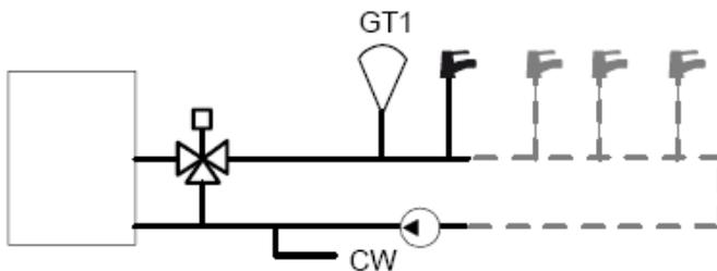
Для этого режима работы необходим обыкновенный датчик температуры приточной воды, который подключается на AI1.
