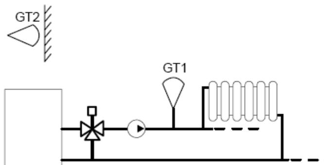
Для этого режима работы необходимо 2 датчика, GT1 - текущая температура, который подключается к входу AI1, и GT2 - наружная температура, подключаемый к AI2.
