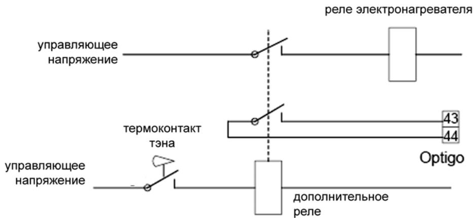
При использовании электрических нагревателей желательно применять ограничение температуры нагрева. В схеме рекомендуется продублировать отключение тэнов по термоконтакту, как это показано на рисунке выше.
