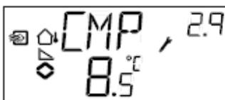
В режиме работы 3 температура приточного воздуха имеет максимальное и минимальное ограничение. В этом меню устанавливается максимальная температура приточного воздуха.
