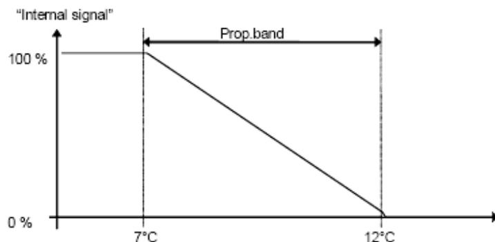
Сигнал защиты от замораживания будет линейно нарастать, и достигнет значения 100% в 7°C. В этой точке сработает аварийный сигнал замораживания. При этом вентилятор остановится и контроллер войдет в режим останова.
